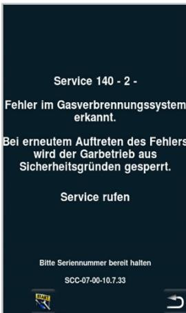
4回目のエラーが発生すると、調理稼働は、エラーメッセージ「サービス 140-16」（床置型ユニットの下部ホットエアーガス接続では「サービス 140-32」）とともに、予防措置としてならびにユニットの二次損傷を防ぐためにブロックされ、メンテナンス後にサービスによってのみリセット可能となります。
