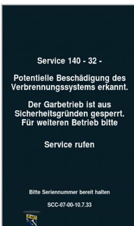
これにより、ガス式ユニットのメンテナンスが不十分な場合でも、ガス供給または燃焼システム内のコンポーネントが正常な状態である場合のみユニットを操作できるようになります。
