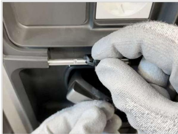
3. 適切なサイドカッターを使用して、長穴のところで軸を2つに切断します。
