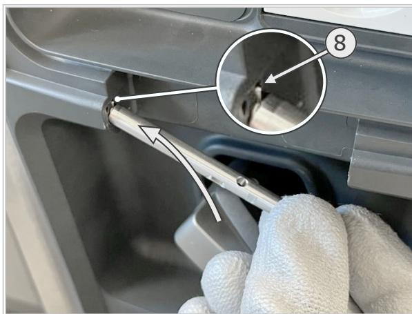
5. スプリングスリーブ 5 を少し押し縮め、金属軸を右側の受け部分に挿入します。
