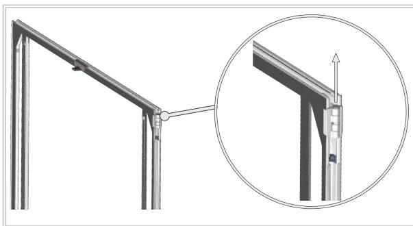
2. ヒンジの反対側にプラスチックキャップを取り付けます。
