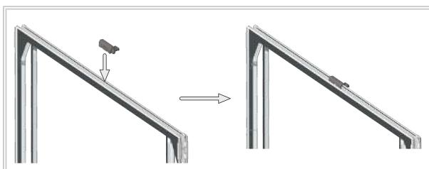
5. 新しいガラスペーンパッケージをドアのヒンジピンに持ち上げます。プラスチックキャップは常に上部にあります。
