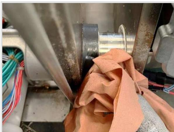
2. 内側のベアリング (5) を鏽落としと布で丁寧にクリーニングします。
