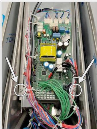
6. ボードキャリアを垂直に置き、付属の切り込みに吊り下げます。
