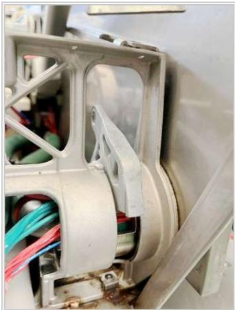
5. 固定プレート（4）とねじ（3）を再び取り付けます。
