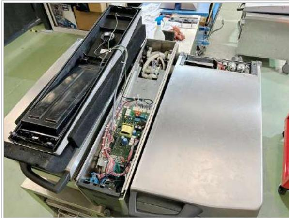
4. 給水パイプの安全クリップを外し、パイプを外します。
