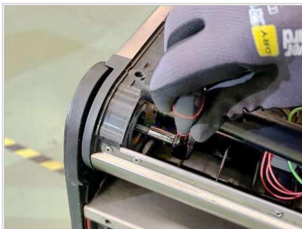
10. 電装部のアウターベアリングの下側の4本のねじを緩めて取り外します。
