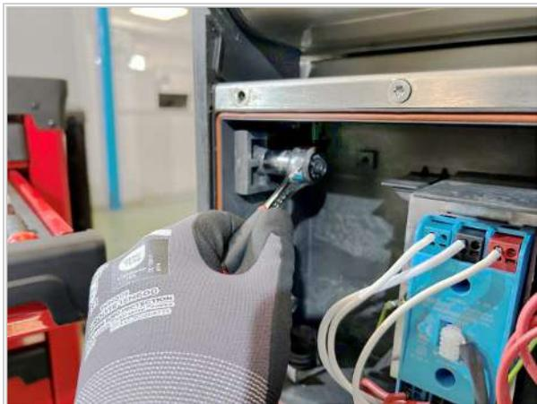
11. ユニットから外側のベアリングと内部のスペーサーを取り外します。
