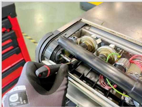
> アウターベアリングの取り付けが完了し、続いて蓋の位置合わせが行われます。
