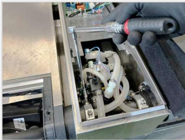
3. 電装部のアウターベアリングにある4つのナットを15 Nmで締め付けます。
