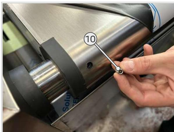
2. この位置にキャップボルト（11）を挿入して、平行キーを固定します。
