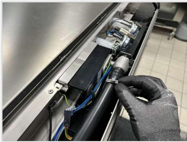
7. 外したコネクタと圧力ホースを、媒体の通し口を通して電装部に向かって引き出します。
