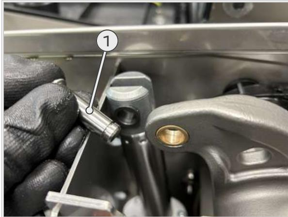
2. グラブねじ（2）をゆるめ、完全に回して外します。
