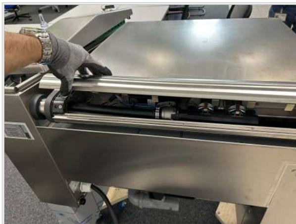
3. 圧力センサー、2つの安全圧力スイッチ、ボールバルブのコネクタ (6) を外します。
