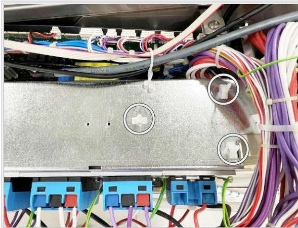
5. ケーブルハーネス W32 (6) のケーブルをエネルギー最適化ボードに接続し、ねじで固定します。
