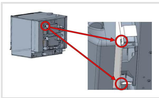
6. カバープレートを左にスライドさせ、カバープレートを外します。
