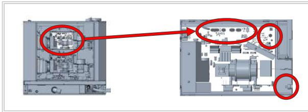
8. 3 本の固定ナットを取り外して、ボードを取り外します。
