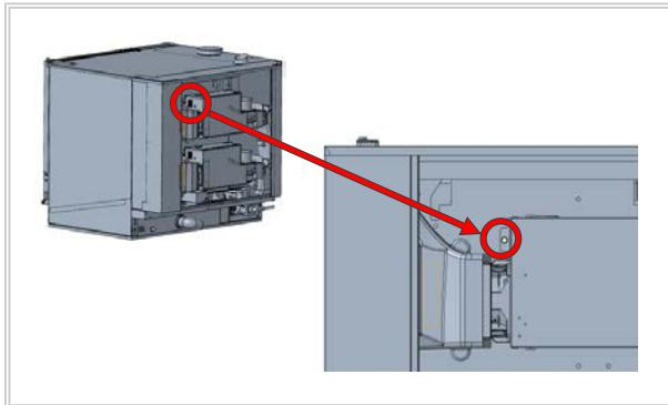
5. 連結金具を折り曲げて開き、冷却ファンをアンロックします。
