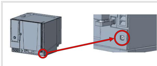
3. ユニット背面の固定ネジを外します。
