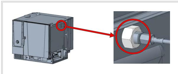
6. 電装部の芯温センサーをI/Oモジュールから外します。
