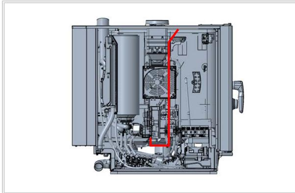
7. 天井下の芯温センサーのプラグを左から右に引き抜きます。
