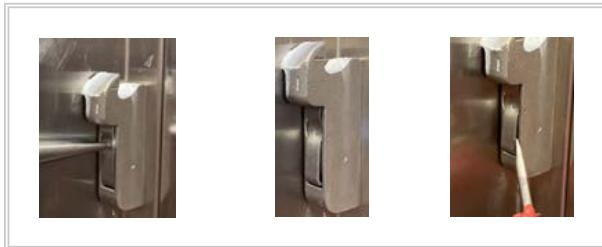
2. ドアキャッチカバーからネジを外します。
