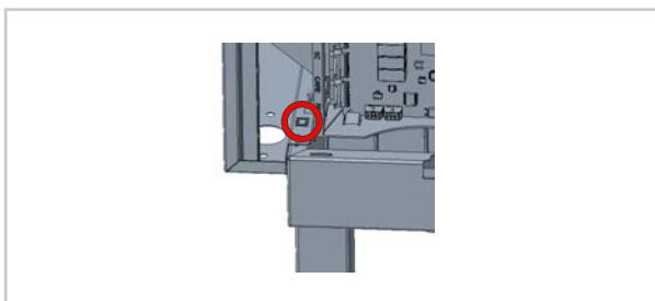
8. リアパネルを慎重に左方向にスライドさせ、慎重に上方向に外します。
