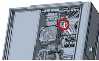
4. 圧力ボックスを外します。湿気ホースを取り外します。
