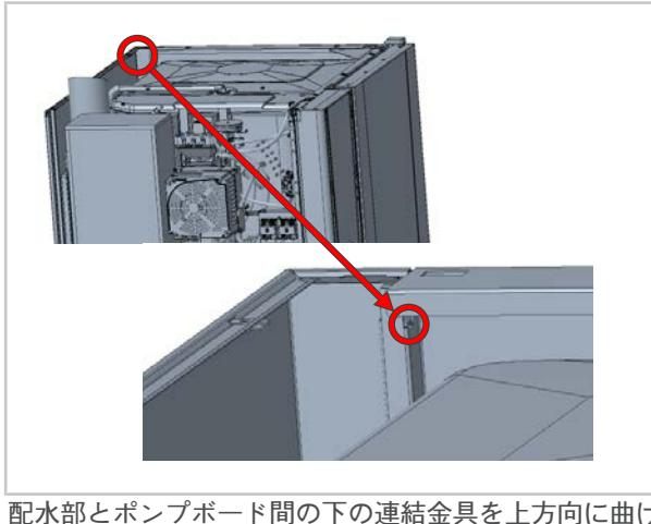
7. 配水部とポンプボード間の下の連結金具を上方向に曲げます。
