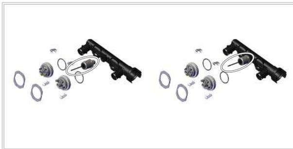
10. 新しい圧力スイッチ (20 mbarと350 mbar) に新しいシールを取り付けます。
