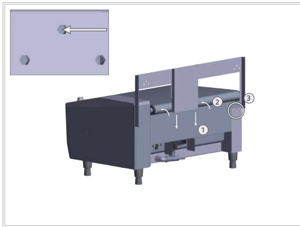
5. カバーの蓋をカバー(1)に差し込み、これを左右両側でねじで固定します(2)。
