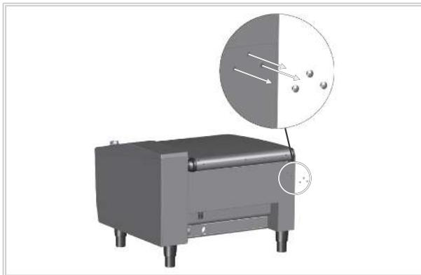
4. カバーパネルを上から煙突パーティション(1)にスライドさせ、このカバーパネルをユニットの後板(2)に引っ掛けます。リアパネルの左側でM10x40六角ねじをねじ込みます(3)。
