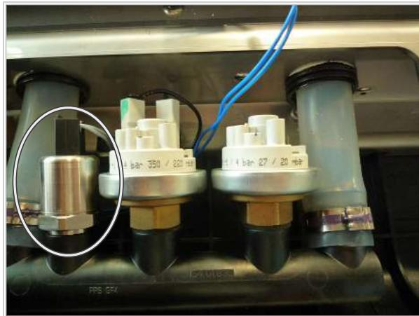
2. 圧力センサーをネジ山を回わして外し、圧力センサーからアース線とシールリングを取り外します。
