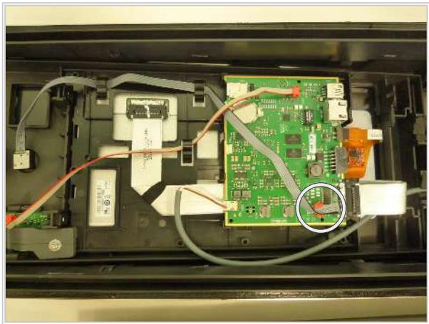
1 | パルス発生装置の取り外しと取り付け
