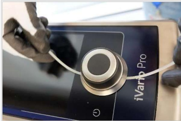
6. パルス発生装置を取り外すためにナットを外します。
