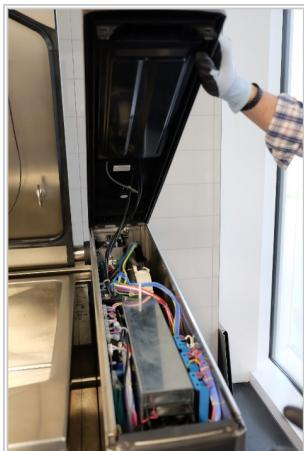
3. 両方のプラケットを下に押して、カバーを外します。
