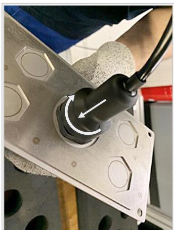
7. LANケーブルを、電装部を通し、開口部を通して操作パネルまで引き上げます。
