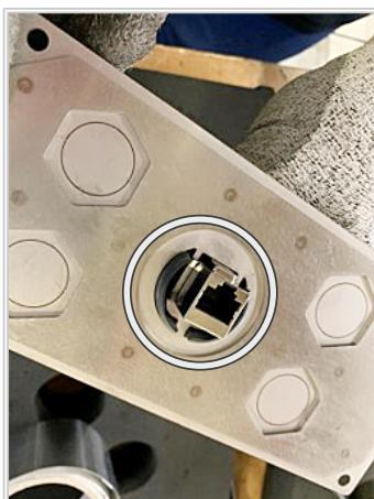
5. これをユニオンナット (6) で固定し、保護キャップ側でLANケーブル (7) を挿入します。
