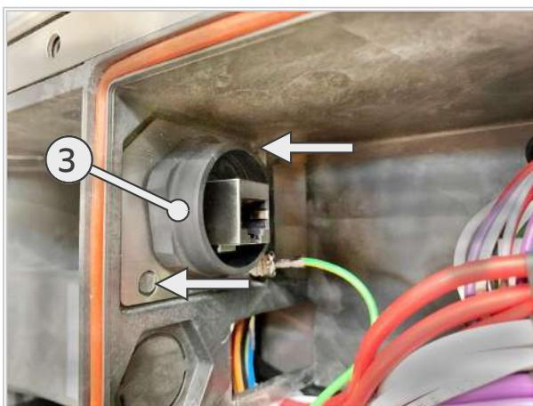
7. 必要に応じて、マルチパーツLANプラグハウ징を、先に取り付けたネジ接続部にねじ込みます。
