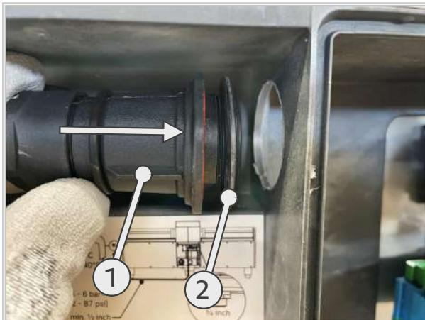
5. LANプラグハウジングとLANアダプタープラグの付いた金属プレートを取り付けます。
