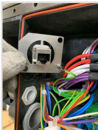
3. フラットガスケット (2) をLANプラグハウジング (1) の接触面に当てます。
