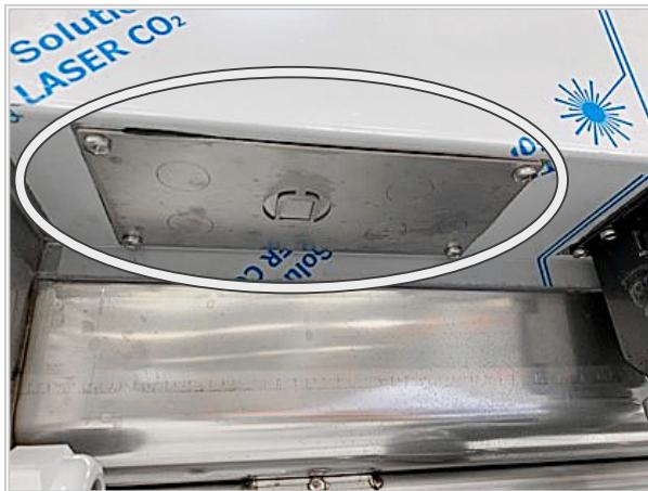
2. 適切な道具を用いて、プレートの中央の打抜き穴を打ち抜きます。
