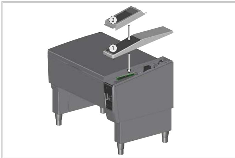
3. 操作パネルの上にロック付きのカバーを付けてください。カバーが正しくつけられているか確認して下してください。
