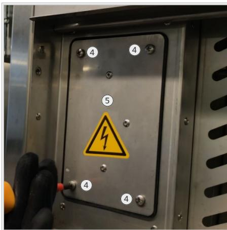
5. 電気ボックスの蓋 (5) を引き出します。これは制御基板 (6) (品番: 42.00.308S) と追加基板「フィルター検出 RAL321」(7) (品番 42.00.309S) の両方のキャリアです (UltraVent Plus搭載の場合のみ)。
