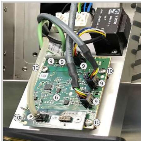
7. 制御基板 (6) の4つのネジ (10) をゆるめます。
