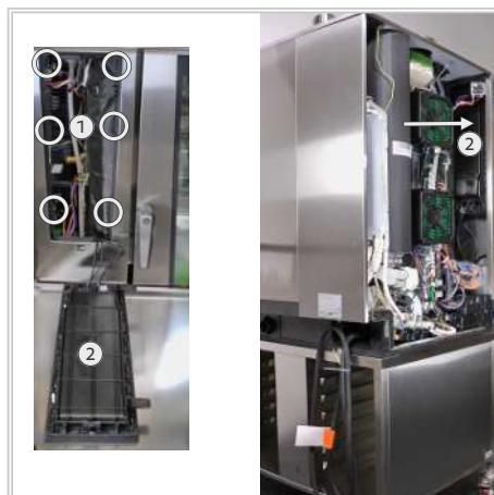
2. **iVario** : コンソールパネルのカバーを開けて、2本のねじを外します (10)。操作パネルを取り外します。操作パネルに引っかき傷がついたり、損傷が生じたりしないように、パンのカバーに段ボールや緩衝材などの保護材をかぶせます。
