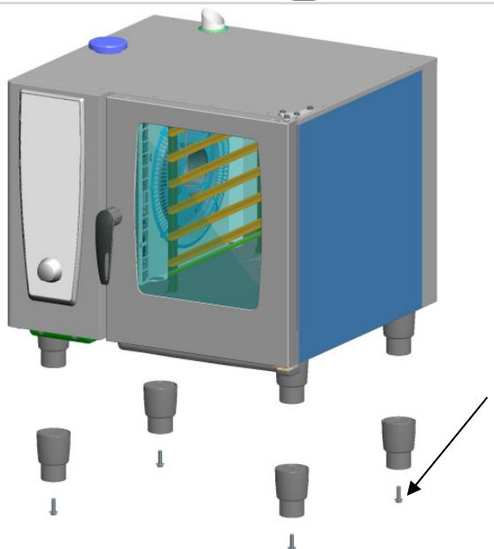
機器脚部のネジを緩めて取り外します
