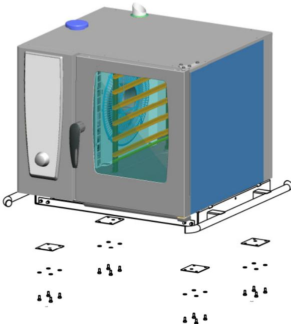
付属のネジを使って 4 枚の底板を取付けます。
